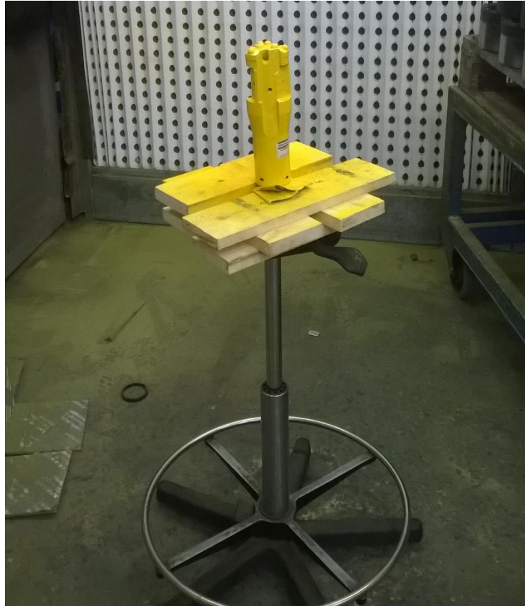
Kuva 33: Maalauksen prosessitutkimusta varten suunniteltu teline.
