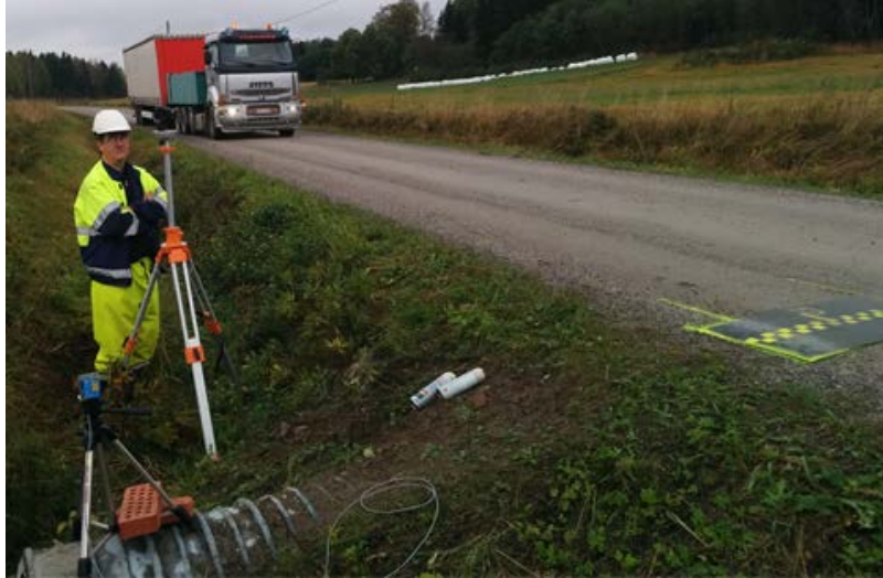
Kuva 21. Ajoneuvon ajolinjan mittaaminen.
