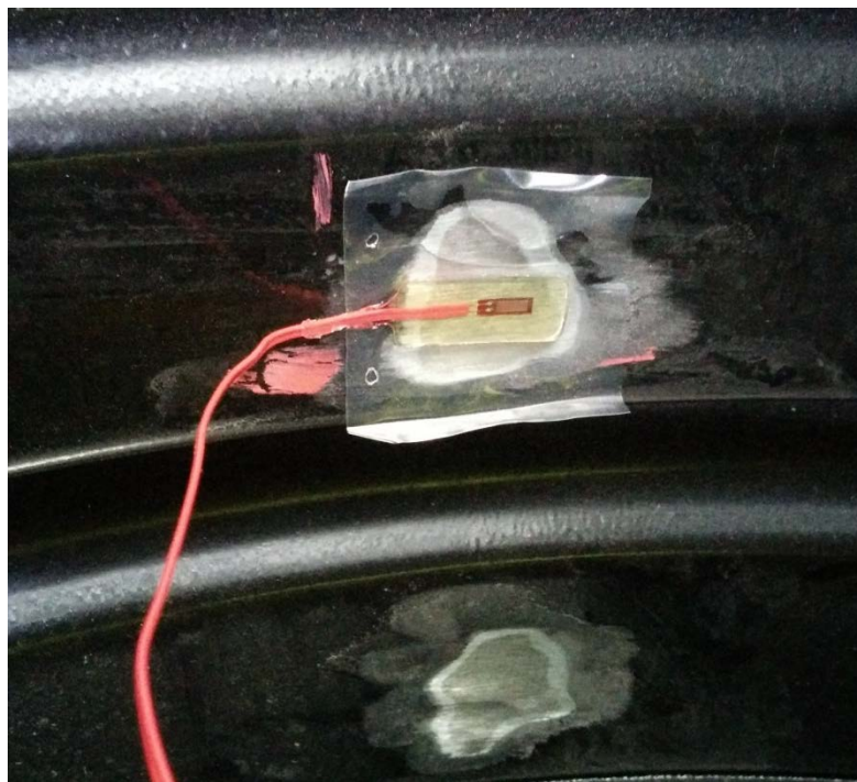
Kuva 20. Venymäliuska asennettuna. Vieressä toiselle liuskalle valmisteltu kohta.
