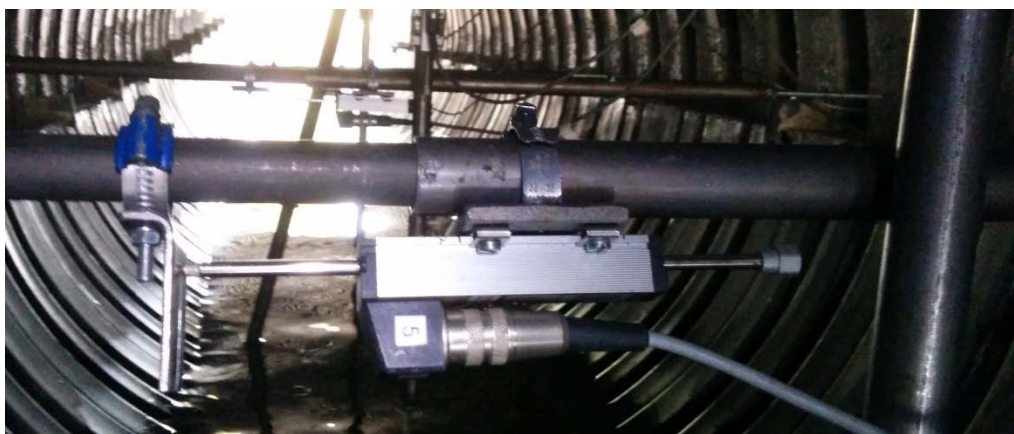
Kuva 19. Halkaisijan muutoksen mittaamiseen käytetty siirtymäanturi.
