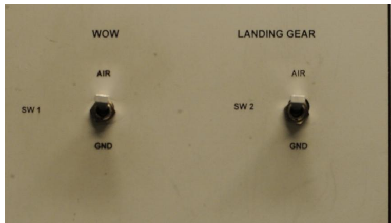
Kuva 25 Diskreettikytkimet järjestelmäpaneelin etulevyssä
