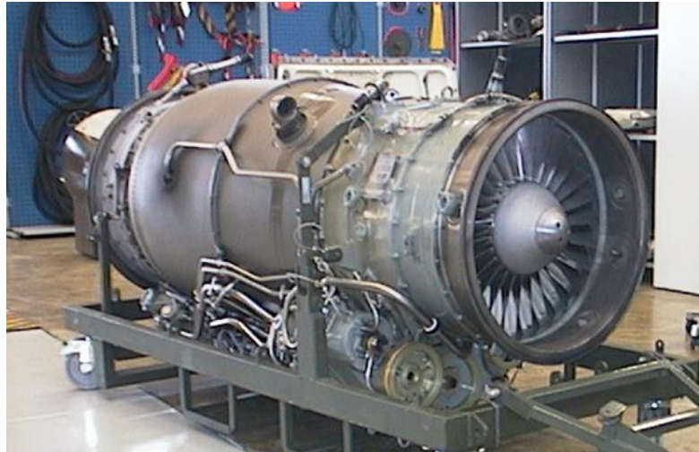
Kuva 1 Rolls Royce Turbomeca Adour Mk.851 huoltotelineessä[6]
