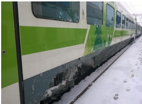
Kuva 36. Jäätä junan rakenteissa Kajaanissa 30.3.2015.
