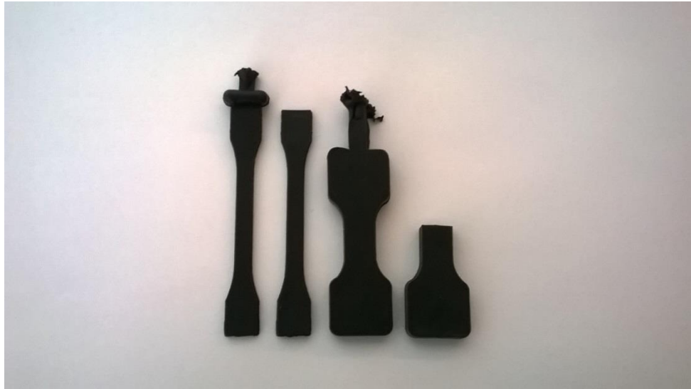
Kuva 28. Testikappaleiden mallit. Vasemmalla on esimerkiksi vetokokeissa käytetty pie- nempi koiranluu. Toisen oikealta on öljyaltistuksissa käytetty suurempi koiranluu. Oike- alla on suurempi koiranluu leikattuna öljyaltistuksessa käytettävään muotoon.
