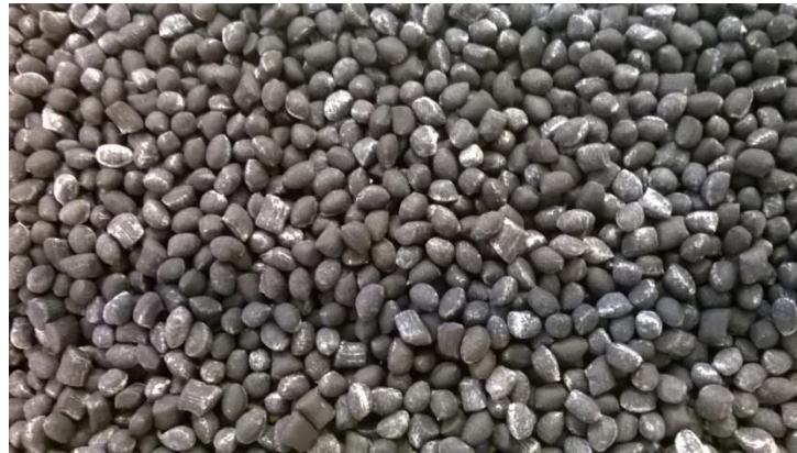
Kuva 43: Materiaalin A kosteissa olosuhteissa termisesti vanhennettuihin granulaatteihin tarttui vanhennusastiasta irronnutta valkoista jauhetta
