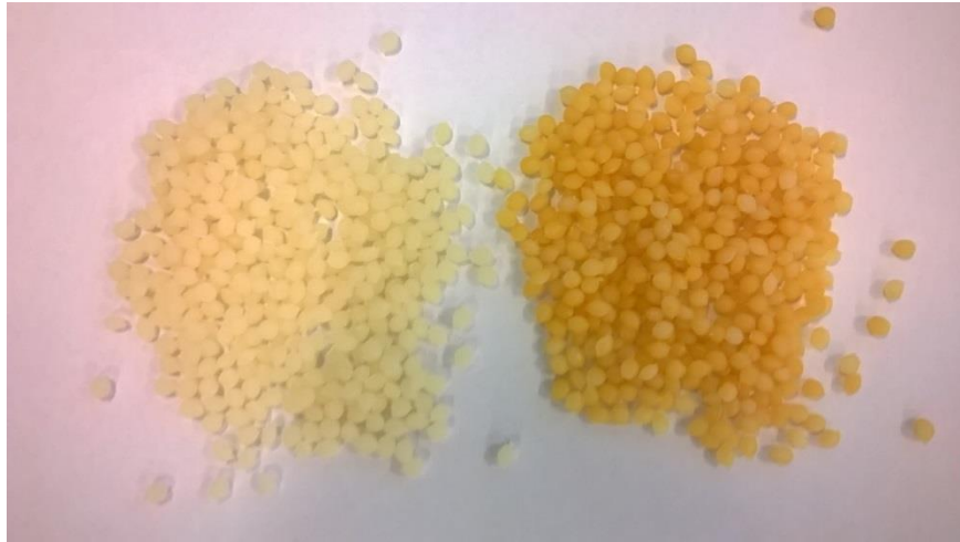
Kuva 45: Materiaalin C väri kellastui voimakkaasti UV-vanhennuksessa
