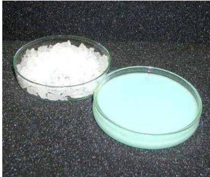
Kuva 4.6 Rubitherm SP (suolahydraatti-parafiiniseos) (Rubitherm GmbH).
