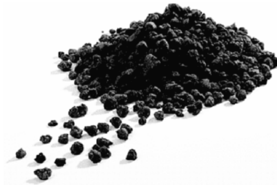
Kuva 4.9 ECOPHIT GC20 -PCM-grafiittiseos, joka on valmistettu sekoittamalla paisutettu grafiitti ja PCM-materiaalia (SGL Group).
