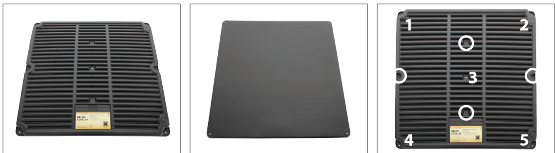
Kuva 4.32 Dörkenin DELTA ® -COOL 24 levy. Vasemmalla levyn yläpuoli ja keskellä alapuoli. Oikeanpuoleisesta kuvasta nähdään levyssä olevat viisi valmista kiinnityspistettä. Tarvittaessa levy voidaan kiinnittää myös ympyröidyistä kohdista poraamalla. (Dörken GmbH)
