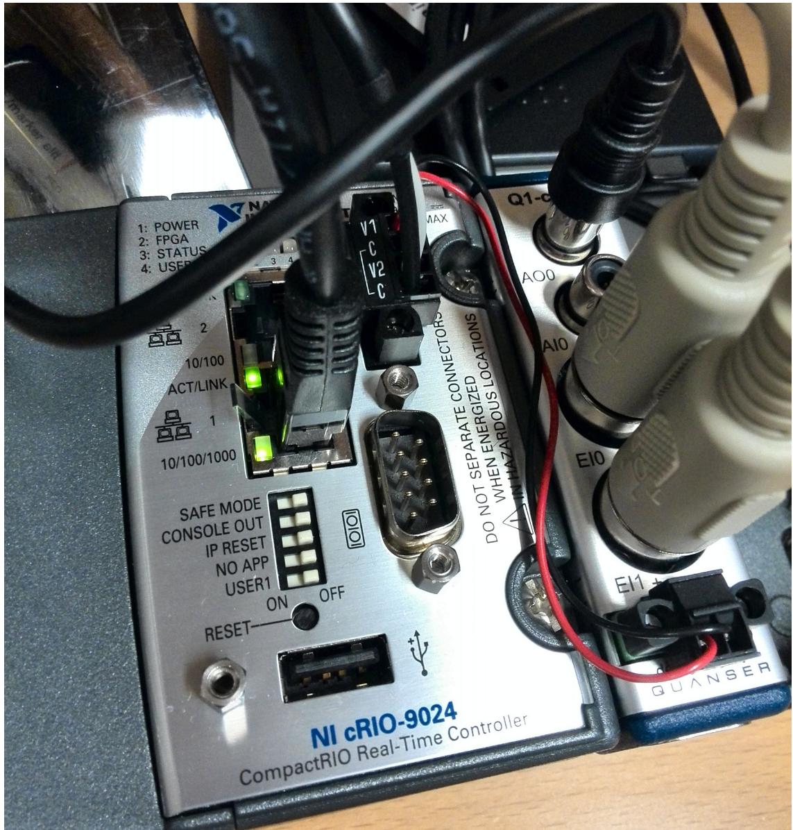
Kuva 8: National Instruments CompactRIO ja Quanser I/O-moduuli
