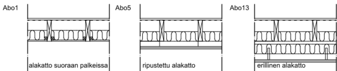
Kuva 35: Leikkauskuvat välipohjarakenteista, joissa alakattotyyppi on parametrina, mittakaava 1:20.
