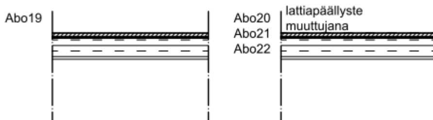
Kuva 42: Lattiapäällysteen vaikutuksen selvittämiseen käytetyt välipohjarakenteet, mittakaava 1:20
