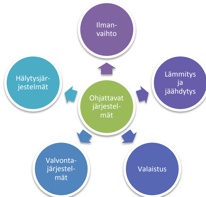
Kuva 45. Rakennusautomaation kautta ohjattavat järjestelmät sähköasemalla.
