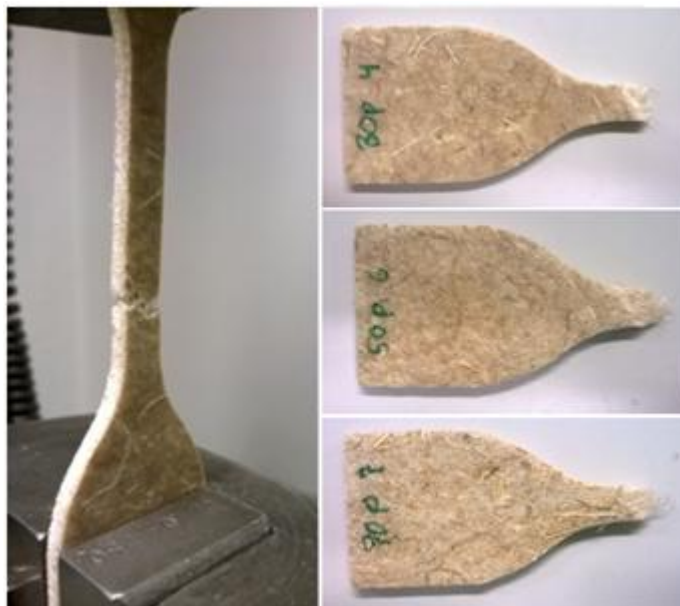
Kuva 9.2. Vetokoekappaleiden murtumistapa. Vasemmalla on kuvattu 30 prosenttia pellavaa sisältävä koesauvan vetokoetestaus ja murtuman synty. Oikealla kuvatuissa koesauvoissa on nähtävissä murtuneen sauvan kuitupitoinen pää (ylhäältä alaspäin 30 % pellavaa, 50 % pellavaa, 70 % pellavaa).
