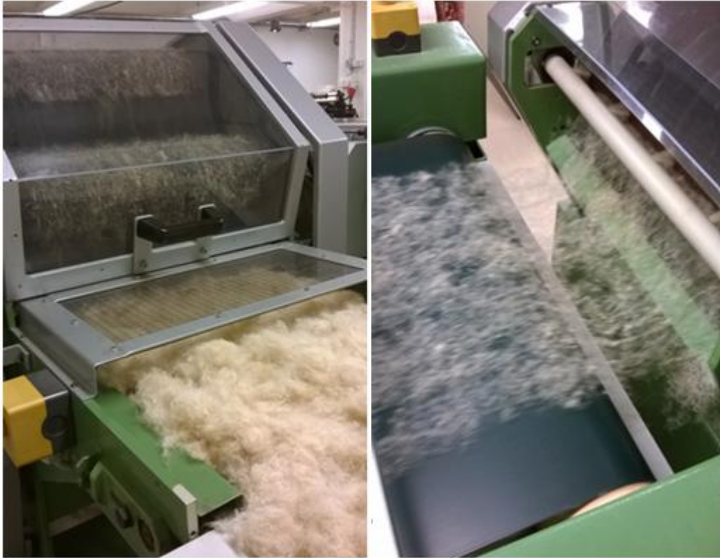
Kuva 7.5. Vasemmalla kuvattu kuitumassan syöttö karstauskoneeseen ja oikealla karstattun kuiturainan poistuminen karstauskoneesta.
