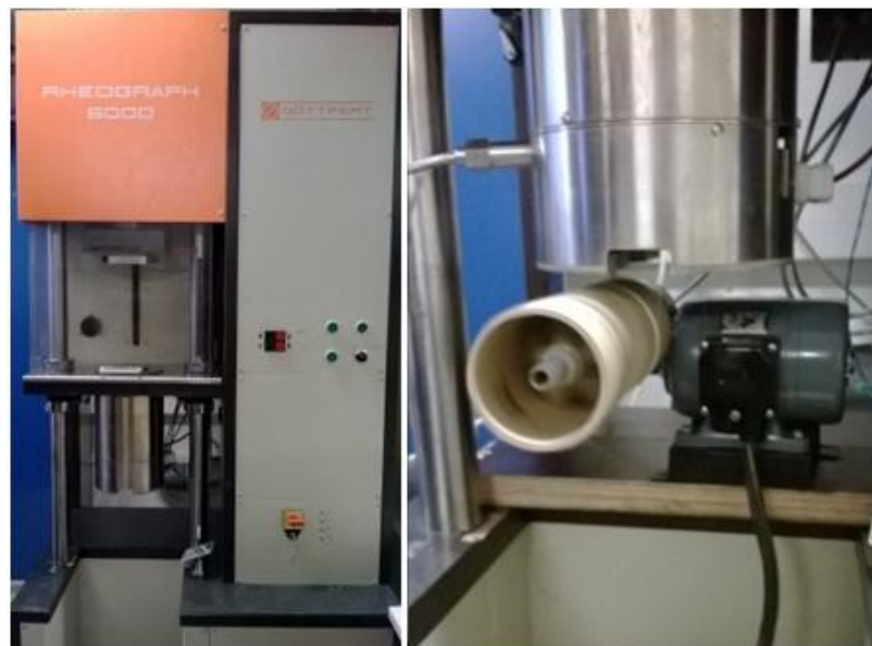
Kuva 7.1. Kapillaarireometritestaus. Vasemmalla on kapillaarireometrilaitteisto ja oikealla testaustilanne, jossa kelausmoottori pyörittää pahvirullaa vakionopeudella ja kapillaarireometrin putkesta ulos tuleva muovikuitu kiertyy pahvirullan ympärille. Kuitu kiinnitettiin pahvirullaan maalarinteipin avulla.
