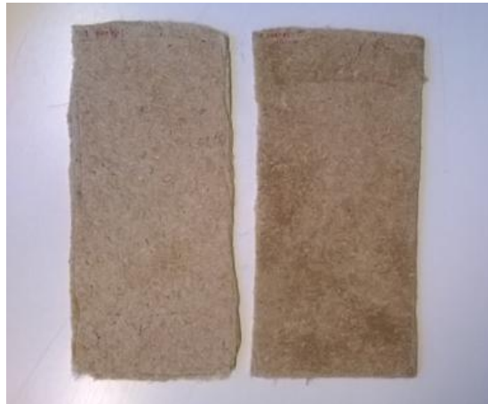
Kuva 7.7. Puristusmuovatut koekomposiittilevyt. Vasemmalla ensimmäisen koeajon kappale, oikealla toisen koeajon kappale. Toisen koeajon kappaleessa on nähtävissä enemmän tummentuneita kohtia, joissa sulanut muovi on kostuttanut kuidut läpi komposiitin.
