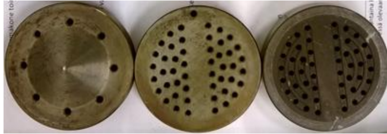
Kuva 5.1. Esimerkkejä sulakuidutuksessa käytettävistä kehrusuulakkeista. Tampereen teknillinen yliopisto.
