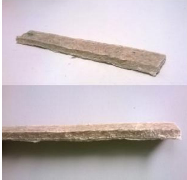
Kuva 7.9. Iskukoekappaleiden työstössä koekappaleiden reuna repesi liiallisesti leikkauksen yhteydessä. Kyseisiä työstettyjä koekappaleita ei käytetty mekaanisessa testauksessa epätasaisen reunan vuoksi.
