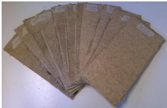
Kuva 7.8. Valmiit puristusmuovatus komposiittilevyt.
