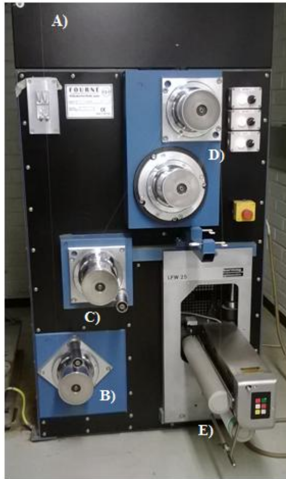
Kuva 7.3. Sulakuidutuslaitteiston kelausyksikkö. Kohdassa A) kuitu valuu ylhäältä ekstruuderin kehrusuuttimen läpi alas lämmitettävälle välirullille B) galetti 1, C) galetti 2 ja D) duo. Näillä välirullilla kuitu edelleen venyy, orientoituu ja ohenee ennen lopullista rullalle kelausta (kohta E)).
