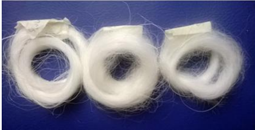
Kuva 7.2. Lämpötilassa 160 °C kapillarireometrin avulla kelatut kuidut. Männännopeudet vasemmalta oikealle: 0.1 mm/s, 0.05 mm/s ja 0.03 mm/s. Männännopeuden pienentyessä myös kuidun halkaisija pienenee.
