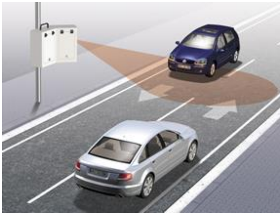
Kuva 2.3. Otolaskentakohteissa käytetyn mikroaaltolaskimen toimintaperiaate (Viatraffic 2014a)
