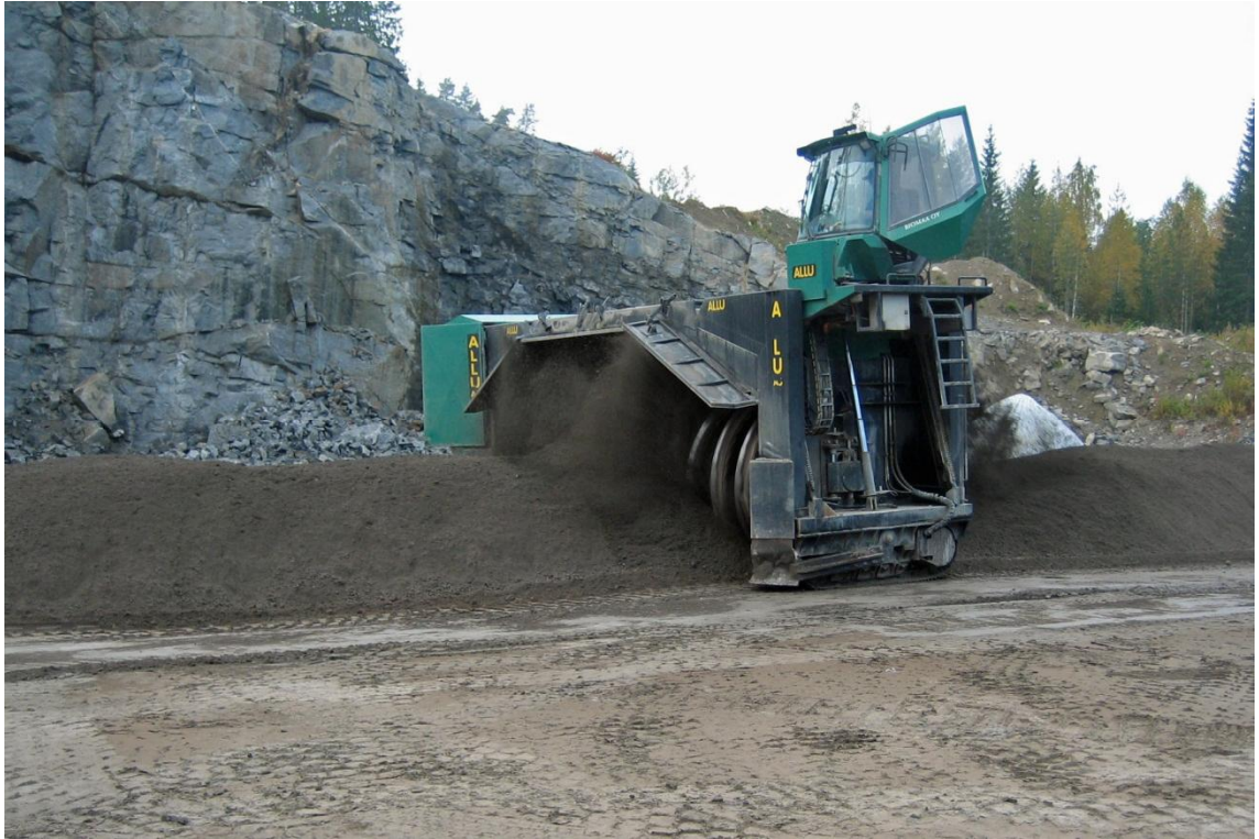
Kuva 4.1 Kuitutuhkan aumasekoitusta Korpilahdella vuonna 2008 (Kuva: Tero Jokinen)
