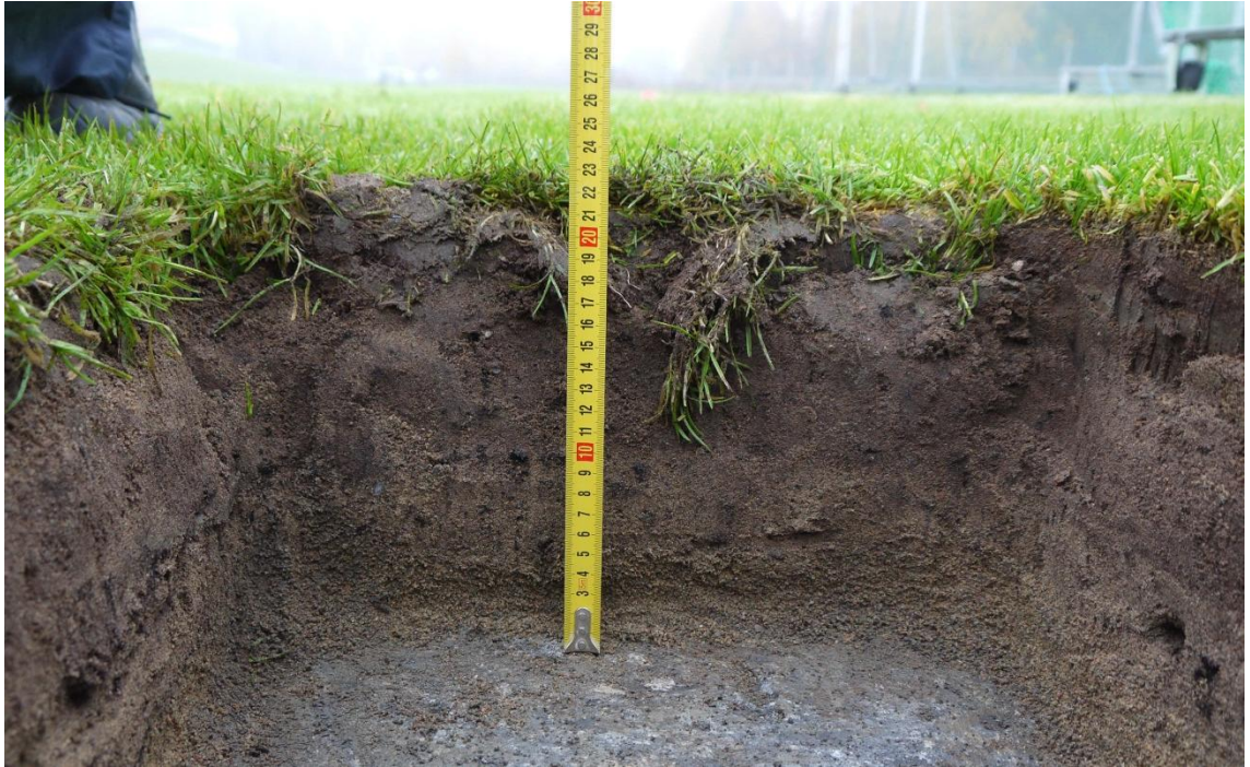
Kuva 7.22 Viialan urheilukentän rakennetutkimus
