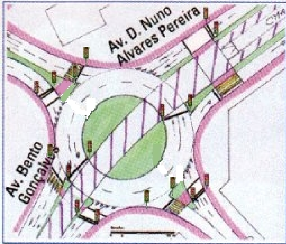
Kuva 55 MST:n reitillä oleva kiertoliittymä ja sen valo-ohjaus (mukailtu lähteestä Futuralmada 2007)
