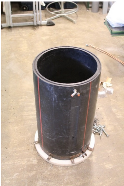
Kuva 4.2. Konvektiolaitteen prototyypin runkorakenne. Putki on noin 1000 mm korkea ja 300 mm halkaisijaltaan. Pohjalla on ilmaa läpäisevä lämmönvaihdin.
