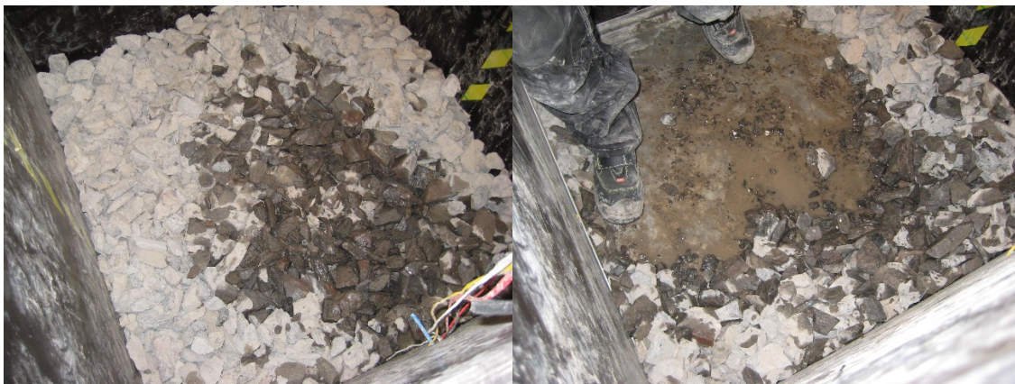
Kuva 5.5. Raideseppelinäytteen purku. Vasemmanpuoleinen kuva on noin 1/3 korkeudelta pohjasta lukien. Oikeanpuoleinen kuva on näytteen pohjalta. Näytteessä on selvästi havaittavissa kuivia kohtia, joissa vesihöyry ei ole virrannut.
