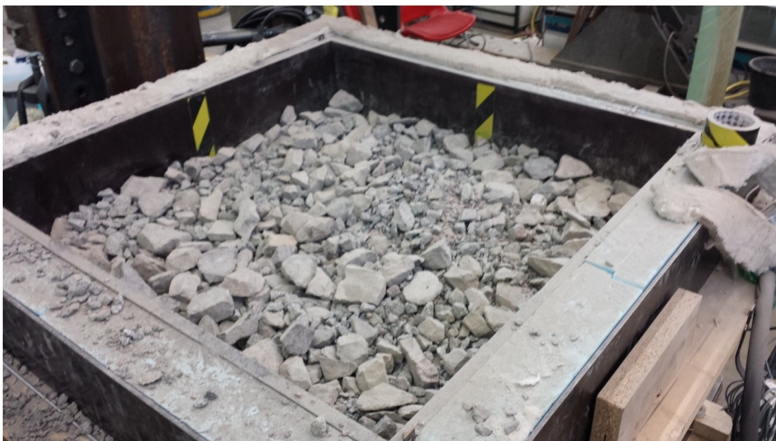
Kuva 4.25. Testeissä käytettävä EV-materiaali. Materiaali sisältää sekä karkeampaa että hienompaa mursketta.
