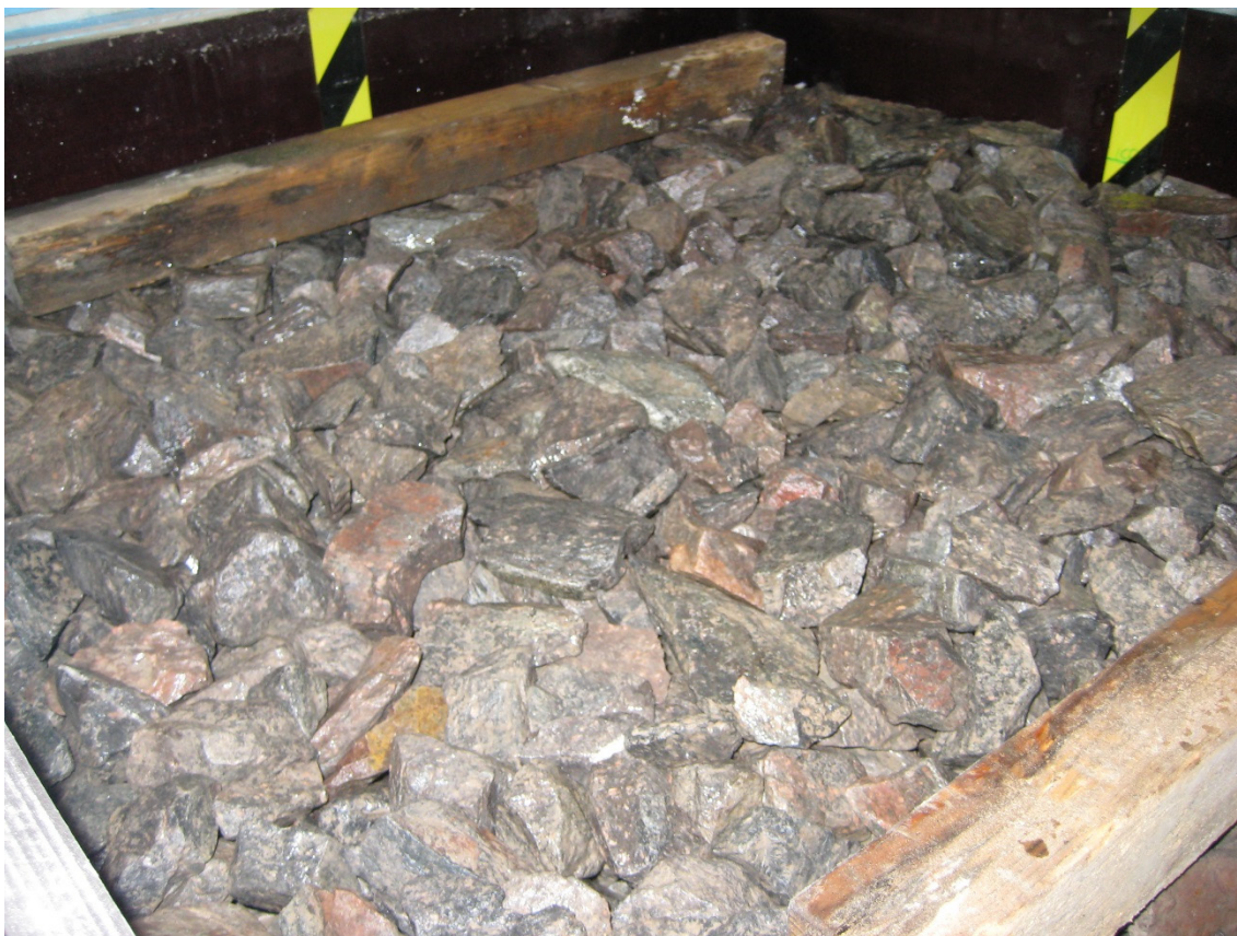
Kuva 4.21. Raidesepelinäyte testiajojen jälkeen. Kuvassa näkyvien puukapuloiden avulla ylälämmityslaatua nostettiin irti näytteestä. Näyte on kastunut kostean tilan testauksessa ylhäälle saakka.
