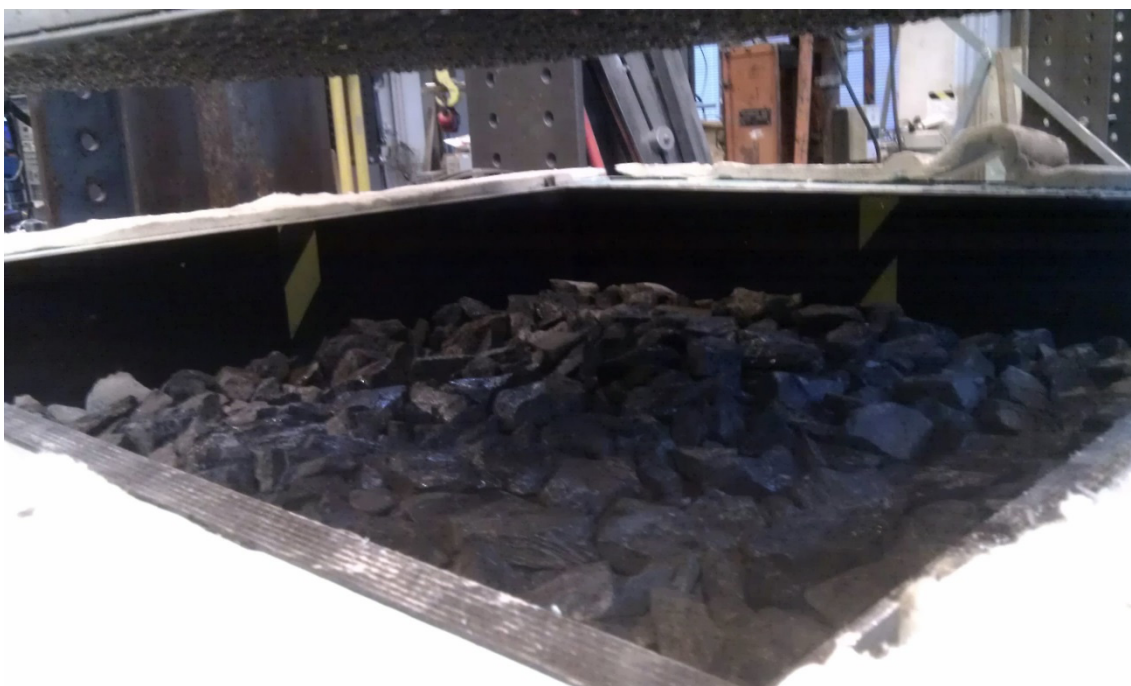
Kuva 5.4. Raideseppelinäyte kostean tilan konvektiokokeen jälkeen. Kun laatikko avattiin, näyte oli selkeästi kastunut ylhäälle saakka ja ylälaatan alapinnassa oli runsaasti tiivistyneitä vesipisaroita.
