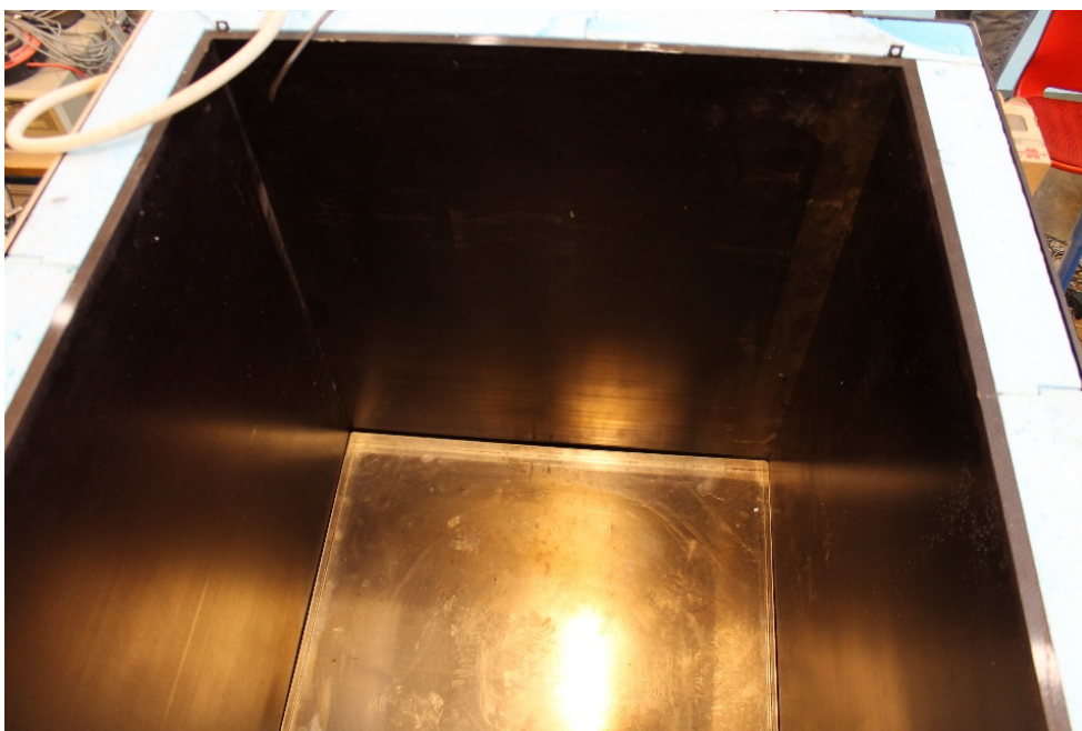
Kuva 4.6. Laitteen näytetila, joka on kooltaan noin 1 m 3 . Pohjalla näkyy alalämmönvaihdinlaatan päällä oleva alumiinikaukalo. Kuvassa näkyy myös seinärakenteen poikkileikkaus.
