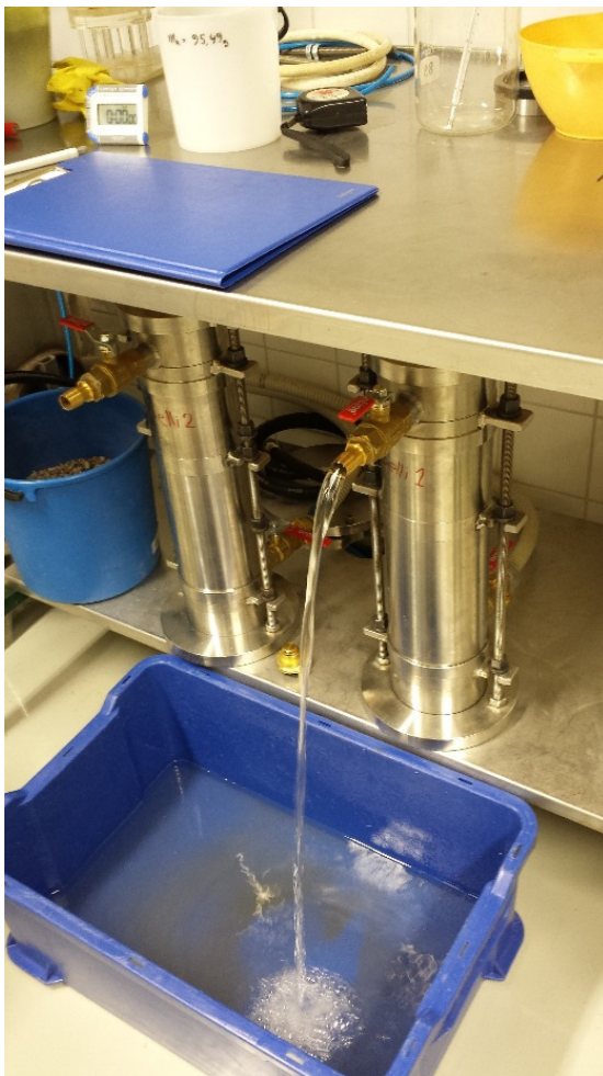
Kuva 4.27. Vedenläpäisevyyskoe käynnissä 5/16mm kalliomurskeelle. Jo 10 mm painekorkeudella vettä tuli todella paljon läpi.
