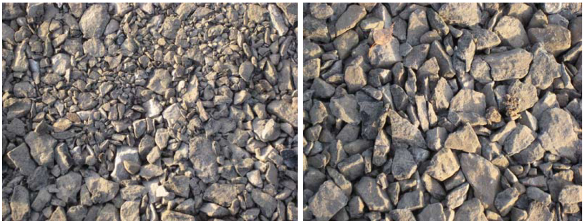
Kuva 6.20. Koepenkereiden rakentamisen yhteydessä kalliomurske havaittiin helposti lajittuvaksi. (Kalliainen et al. 2011)
