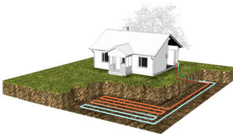
Kuva 3.4. Maaperään vaakatasoon asennettu lämmönkeruupiiri. (Geoenergia 2013)
