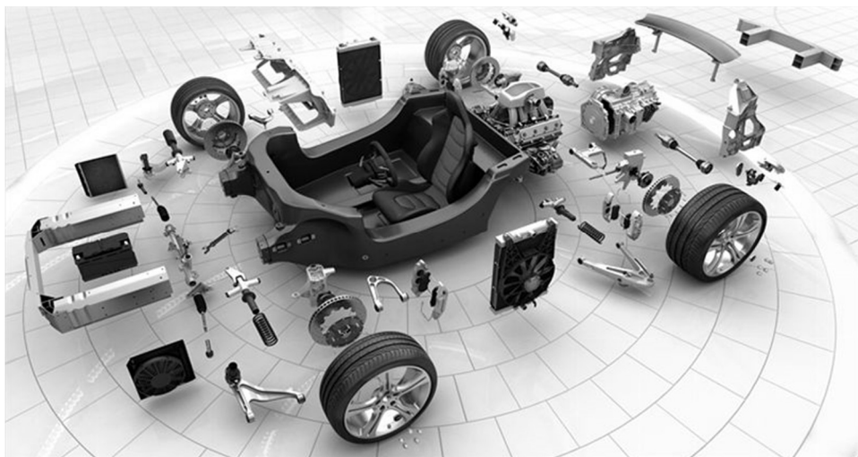
Kuva 24. McLaren MP4-12C:n hiilikuituinen runko. (100)
