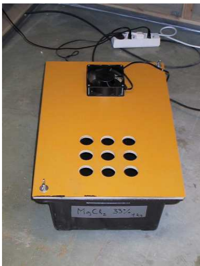
Kuva 3.4 Kosteushuoneen tuulettimella varustettu suolaliuosastia (Mikkilä 2001).
