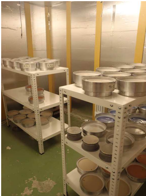
Kuva 3.16 Vasemmalla kosteushuone ja oikealla kosteushuonetta lämmittävä termostaattila varustettu lämmitysvastus.
