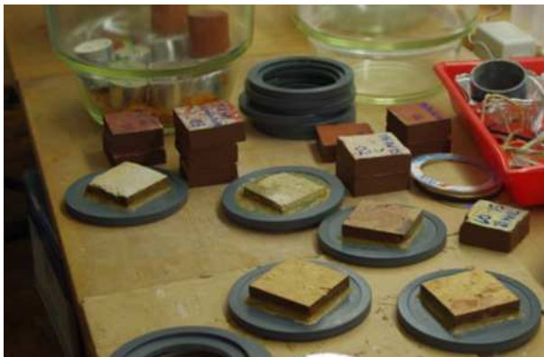
Kuva 3.9 Dresdenin teknillisen yliopiston vesihöyrynläpäisevyyskokeiden koekuppien kansia. Kuvassa näkyy materiaalien tiivistystapa kanteen.
