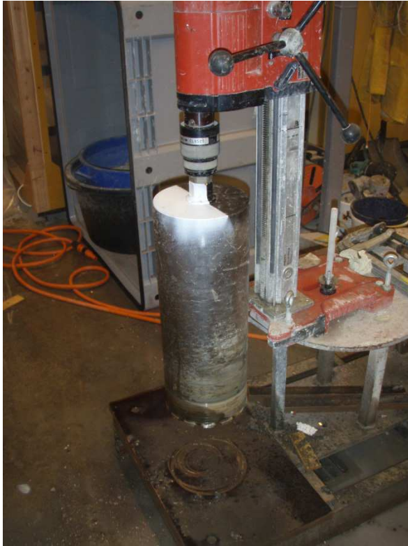
Kuva 4.3 Kivimateriaalien poraus ja sahaus. Ensin materiaalista porattiin timanttioralla halkaisijaltaan 185 mm ympyränmuotoisia kiekkoja. Sen jälkeen kiekot sahattiin sopivaan paksuuteen timanttisahalla.
