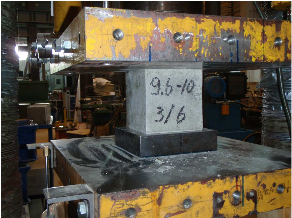
Kuva 4.2 Betonien puristuslujuus testattiin kuutiopuristuslujuuskokeissa.
