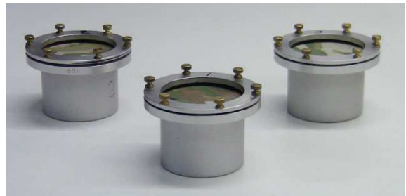
Kuva 3.10 Maalikalvon vesihöyrynläpäisevyyden mittaamisen suunniteltu koeoppi (vasen) ja kalvojen vesihöyrynläpäisevyyksmittauksissa käytetty koeoppi (oikea). (Goossens et al. 2003; Vartest Laboratories [WWW])
