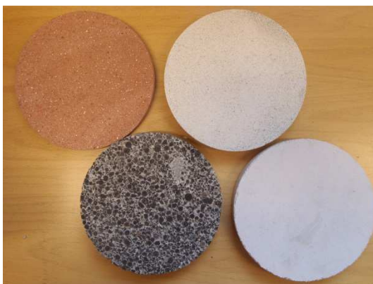
Kuva 4.4 Koekappaleet punatiilestä, kevytbetonista, kevytsoraharkosta ja kahitiilestä.
