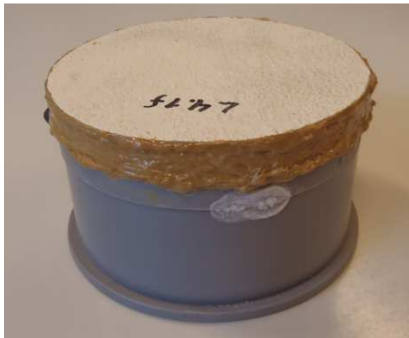
Kuva 3.2 Kupin epätiiviyiskohtan voi havaita kiteytyneestä suolasta.
