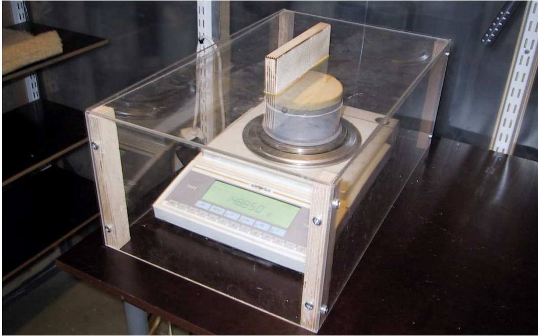
Kuva 3.6 Aiemmin koekuppien punnitukseen käytetty vaaka. Punnituksessa käytettiin suojakotelo, jotta kosteushuoneen ilmavirtaukset eivät vaikuttaisi punnitustulokseen (Mikkilä 2001).
