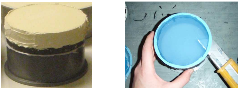
Kuva 4.6 Vanhan menetelmän mukainen koekuppi (vasen) ja materiaalin irrottaminen koekupista suolanvaihdon yhteydessä (oikea).
