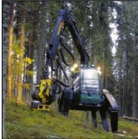
Kuva 4. Plusjack, Prototyyppi kävelevästä harvesterista. [5]
