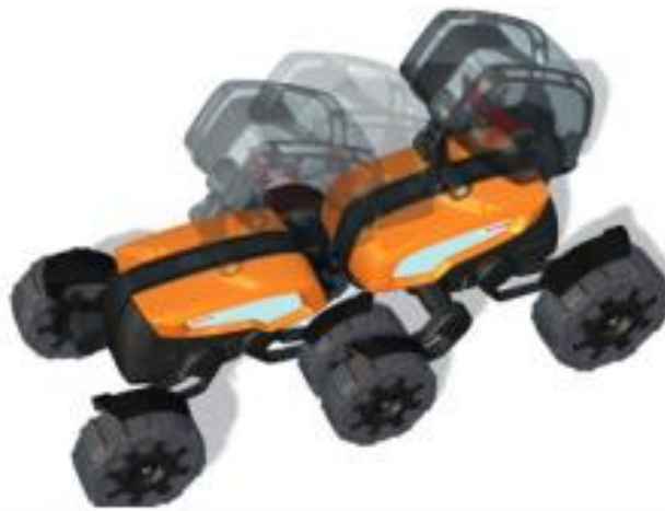
Kuva 8. Kaksi ANTS konetta yhdistettynä. [8]
