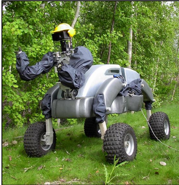
Kuva 9. Aalto yliopiston WorkPartner tutkimusrobotti. [10]
