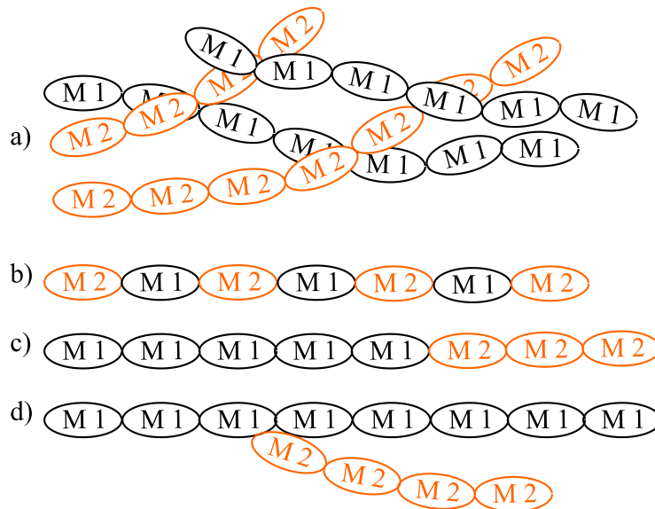
Kuva 3.1: Erilaisten kopolymerien rakenne ja vertailuna myös kahden polymeerin seos. M1 ja M2 viittaavat monomeereihin 1 ja 2, joista kopolymerit muodostuvat. a) kahden polymeerin seos, b) vuorotteleva kopolymeeri, c) lohkokopolymeeri ja d) haarautunut kopolymeeri.
