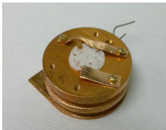
Kuva 5.7: Näyte ja näytteenpidin valmiina ladattavaksi Multilab-laitteistoon. Kuvassa oleva näyte on 40 m-% TCP:a sisältävä huokoistettu näyte.
