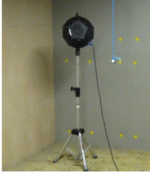
Kuva 3.1. Jälkikaiunta-ajan mittaamisessa käytetty ympärisäteilevä kaiutin.
