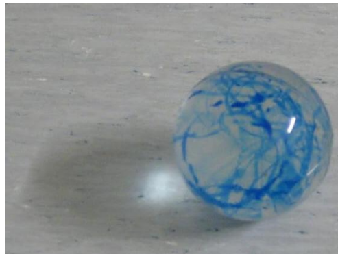
Kuva 3.7. Askeläänitutkimuksessa askeläänilähteenä käytetty superpallo. Pallon massa oli noin 45 grammaa.
