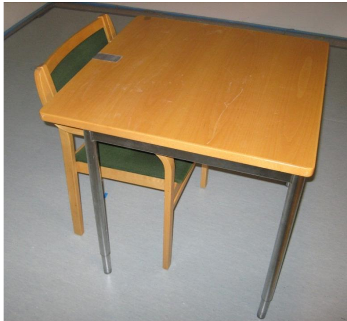
Kuva 3.8. Tuolin siirron koejärjestely liikesarjan alussa. Tuoli ja pöytä asetettiin pituussuunnassa keskelle pintarakennetta ja tuolin siirto aloitettiin siirtämällä tuoli pöydästä pois päin.
