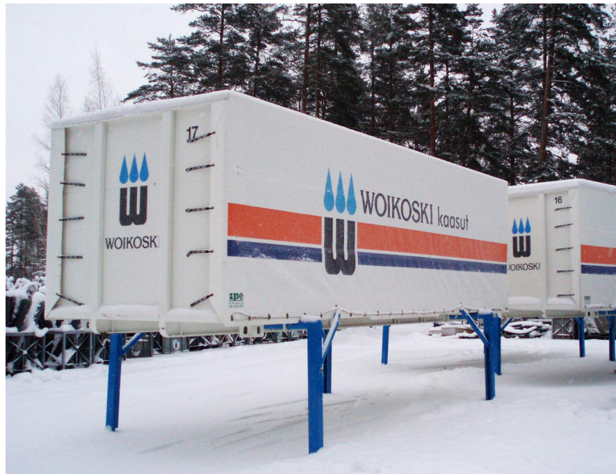
Kuva 21. Pullokonttilava (13 760 l, 200 bar, 247 kg vetyä).
