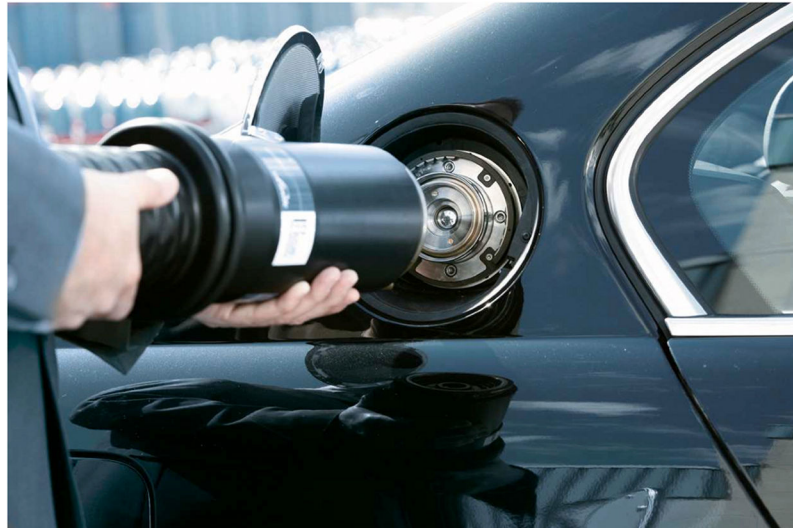
Kuva 27. Esimerkki nestemäisen vedyn tankkausyhteestä [55].
