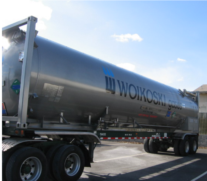
Kuva 22. Nestevedyn kuljetussäiliö (40 954 l, 2 905 kg vetyä).
