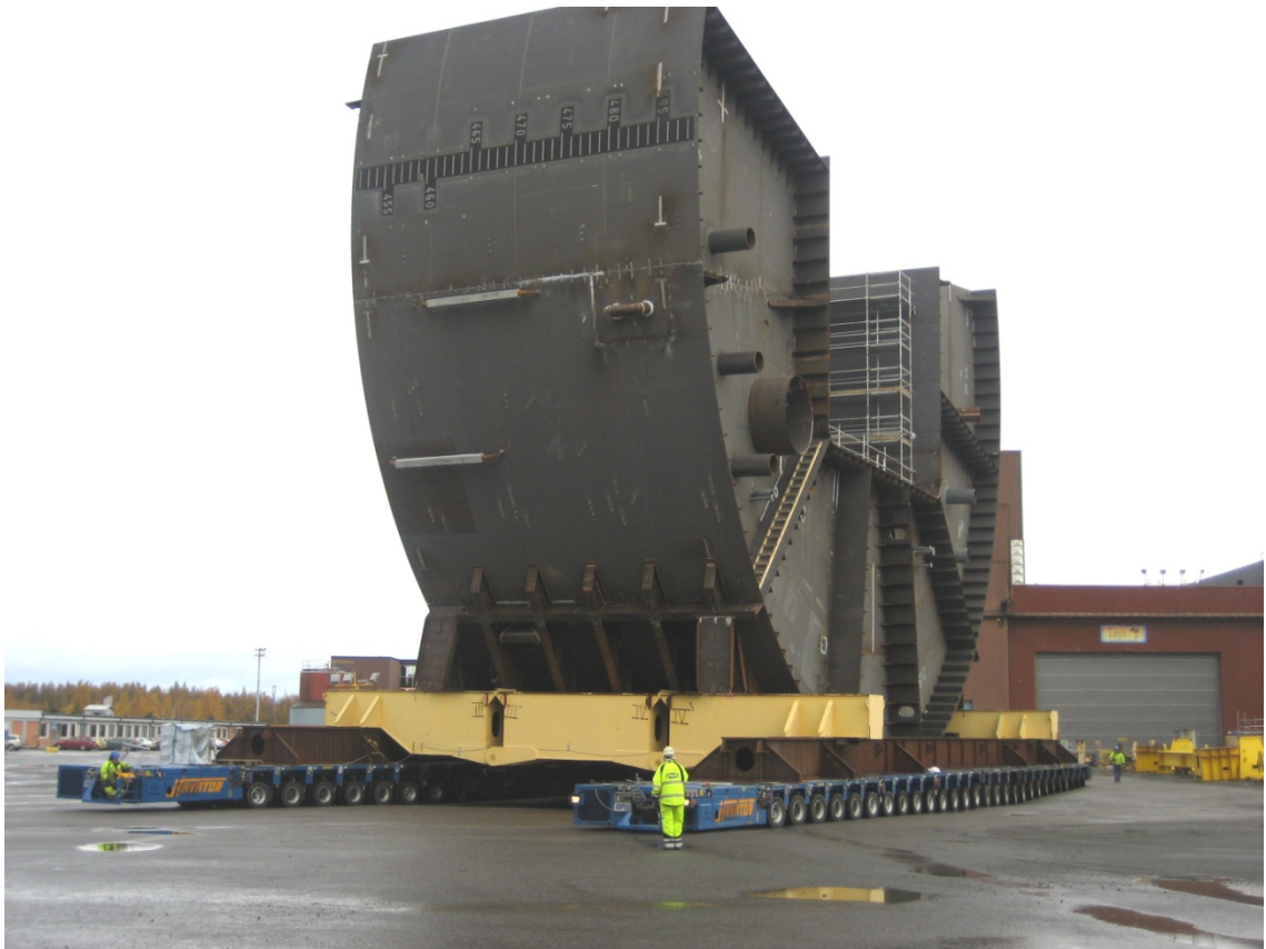
Kuva 4: Kuvassa telakalla siirrettävä lohko, jonka halkaisija on n. 35 m, leveys n. 9 m ja paino n.1000 tonnia. Kuljetuskalustona on 2 x 26 akselinen hydraulisella voimansiirrolla varustettu tietokoneohjattu Goldhofer PST-E moduulilavetti.
