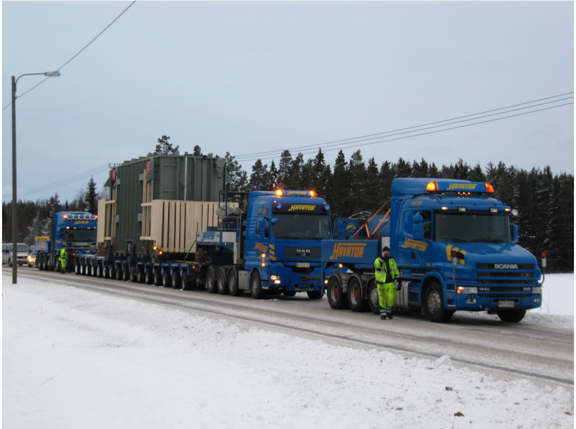
Kuva 1: Kantaverkkomuuntajan kuljetus, muuntajan paino 283 tonnia ja yhdistelmän kokonaispaino yli 400 tonnia.
