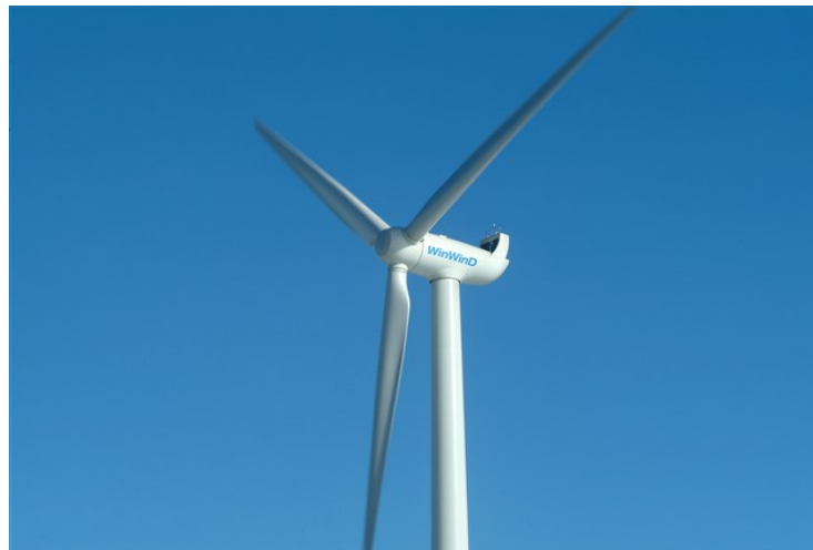
Kuva 2.4. Kolmilapainen aksiaalinen tuuliturbiini [4].
