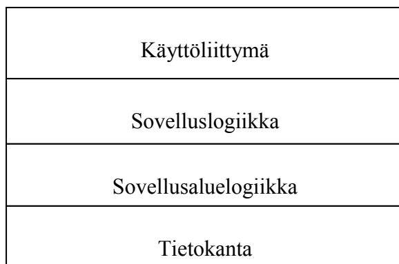
Kuva 2.4 Liiketoimintajärjestelmä, esimerkki kerrosarkkitehtuurin käytöstä [Koskimies ja Mikkonen 2005, s. 128, kuva 6.3]
