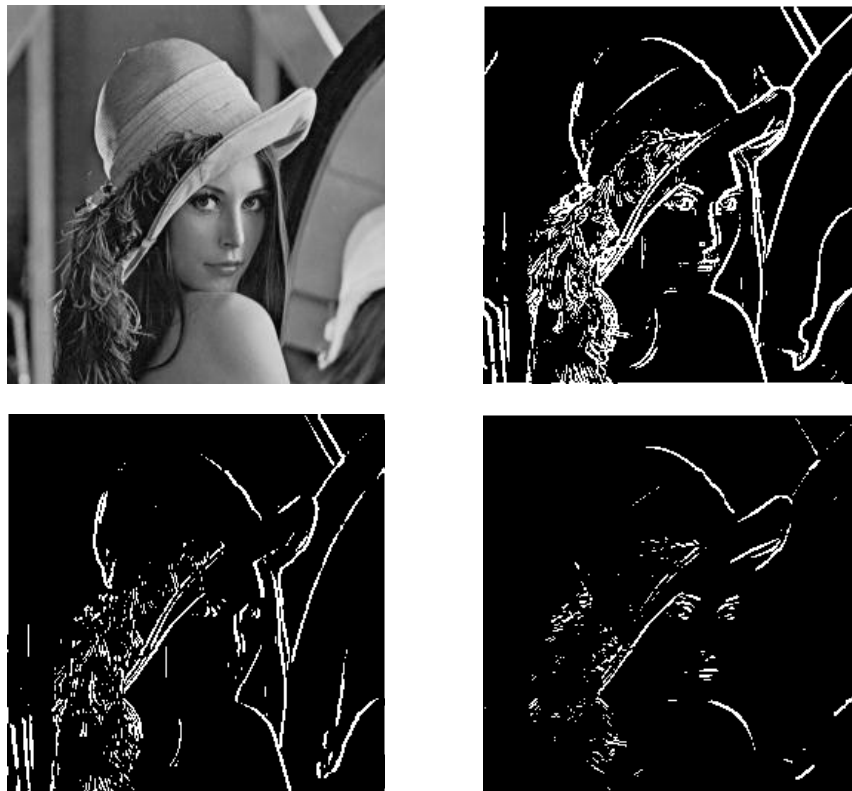
Kuva 3.1.1: Vasemmalla ylhäällä alkuperäinen kuva. Oikealla ylhäällä kuvasta etsityt reunat käyttäen Sobelin algoritmia kynnyksarvolla 0.2. Tulos on alarivin kuvien summa. Vasemmalla alhaalla Sobelin g_x -kernelillä suodatettu kuva ja oikealla alhaalla g_y -kernelillä suodatettu kuva. Alkuperäinen kuva on saatu USC-SIPI [2014] kuvatietokannasta. Kuvat reunoista on prosessoitu alkuperäisestä kuvasta GNU Octavella [2013].
