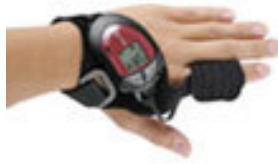
Kuva 4. Iman sykevyötä toimiva sykemittari.
