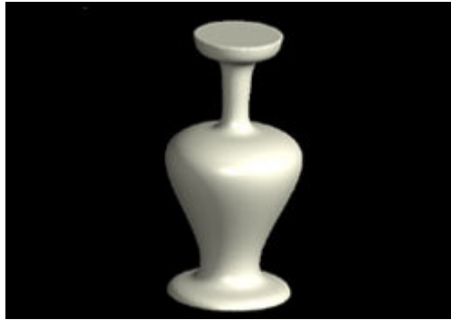
Kuva 17: Yksinkertaisella kaiverruksen ja pyörähdyksen yhteiskäytöllä voi tehdä helposti esimerkiksi ruukun [Sensable, 2005b].
