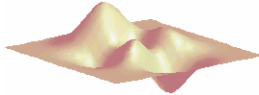
Kuva 13. Neuroverkon virhettä havainnollistava virhepinta. Pinnan oikealla oleva kuoppa kuvaa parasta mahdollista neuroverkkoa.
