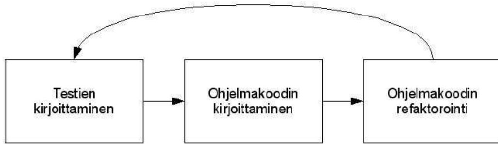
Kuva 7. Testivetoisen ohjelmistokehityksen vaiheet [Makkonen, 2008]
