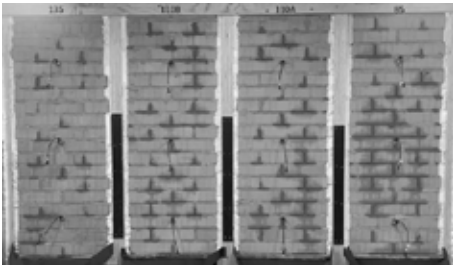
Kuva 2. Koeseinien taustapinnat testin 5 (suurin sadetusmäärä) kaikkien sadetussyklien jälkeen, 9 tuntia testin aloituksesta).
