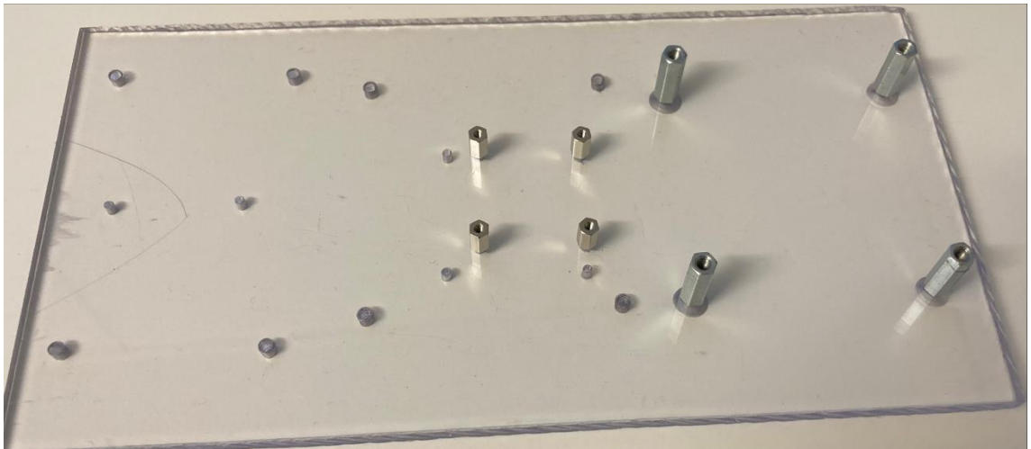
KUVA 6: testijärjestelyä varten tehty muovilevy. Vasemmalle asennetaan Anturin B evaluaatiolevy, keskelle pieniin alumiinitorneihin asennetaan Anturi B ja oikealla oleviin isompiin torneihin asennetaan anturi A:n evaluaatiolevy, sekä anturi A.
