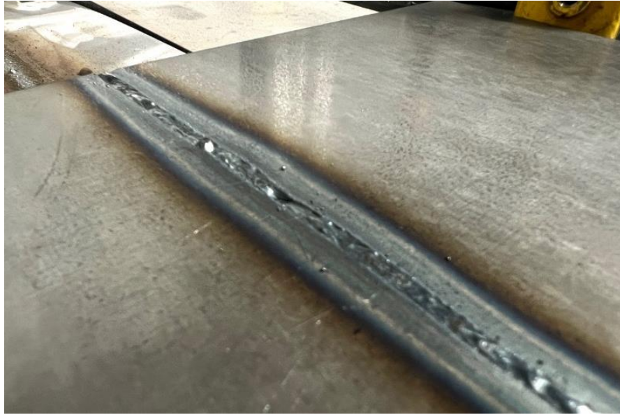
Kuva 5. Laserhitsin pinnan laatuvirheet 511 (vajaa kupu) ja 502 (korkea kupu)
