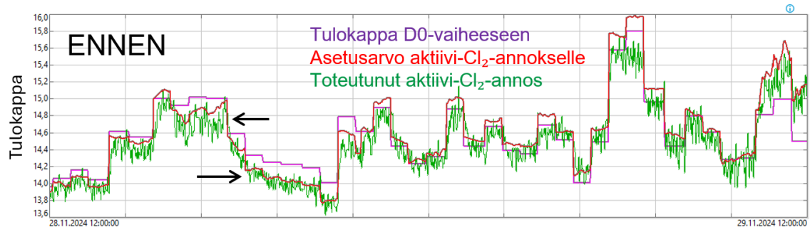
Kuva 44. Annossäätimen toiminta ilman suhteellisen vaaleuden mittausta aktiivi-Cl 2 -annoksenlaskennassa.
