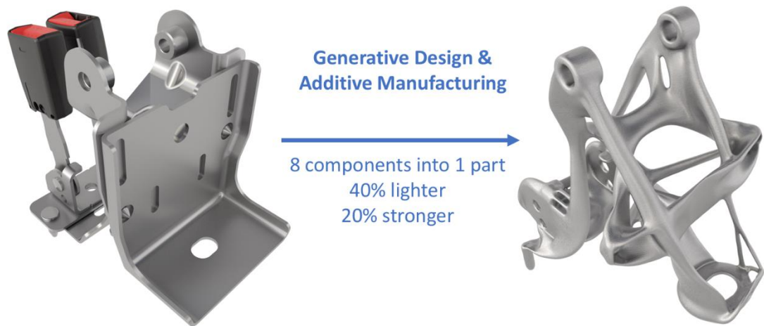
Kuva 4. Turvavyön lukko, joka on Generative Design Toolin luoma, verrattuna tavanomaiseen lukkomalliin (Danon 2018).
