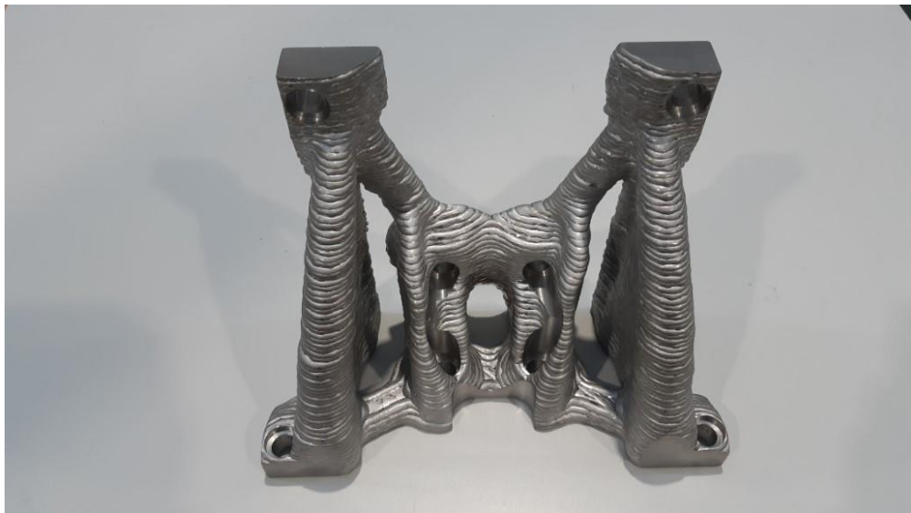
Kuva 1. WAAM:illa valmistettu moottorin tukikappale (Hantula J 2021)
