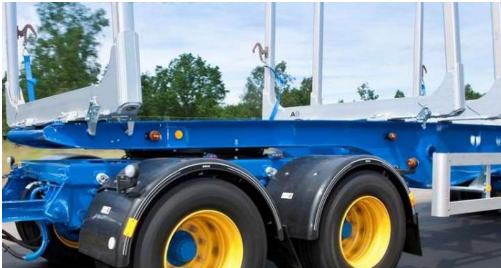
Kuva 22. Strenx-teräksestä valmistetut tukkirekan lastipankon pystypalkit. [92]
