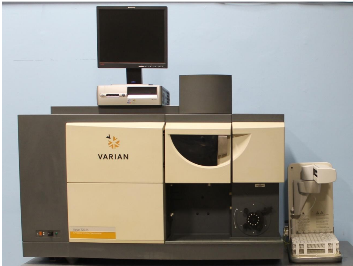
Kuva 11. Tutkimuksessa käytetty Varian 720-ES ICP-OES-laite [42]
