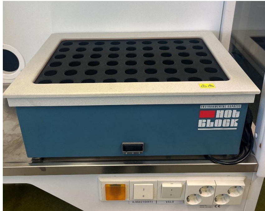
Kuva 10. Esikäsittelyssä käytetty märkäpolttolaitteisto Hot Block
