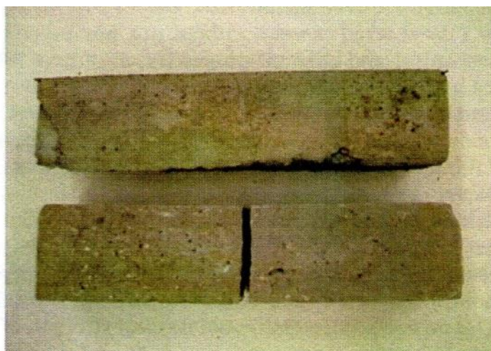
Kuva 5.3. Ylempänä kumirouhe-laastilla tehty koekappale ja alempana PCM-laastilla tehty koekappale. (Meshgin et al. 2012)
