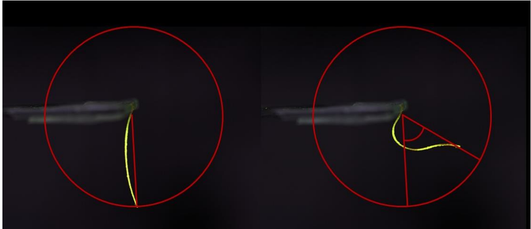
Kuva 21. Aktuaation taipumiskulman määrittäminen. Näytteen taipumisen kulma mitattiin suhteessa alku tilanteeseen ennen valon kytkemistä päälle.
