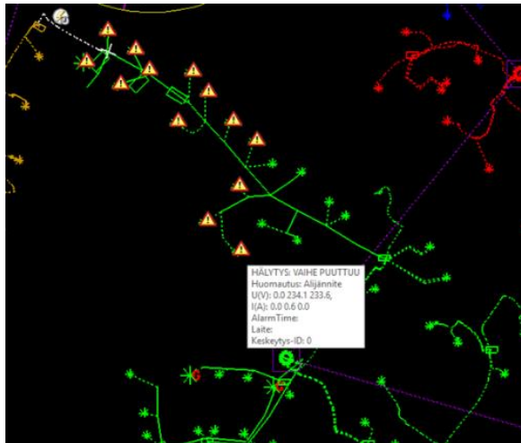
Kuva 28. Vaihe puuttuu -hälytyksiä johtuen kaapeliviasta. Hälytyksen mukana tulee lisätietoa jännitteistä ja virroista sekä mahdollisista huomautuksista.
