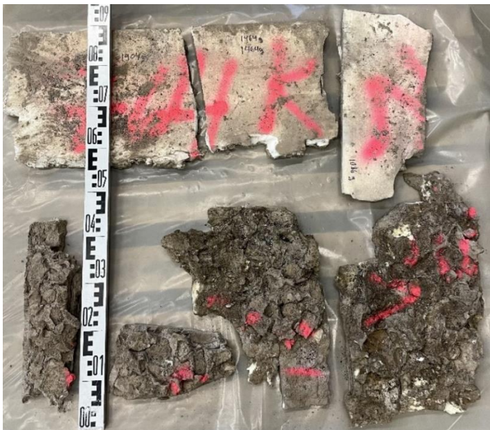
Kuva 16. Ylärivissä levynäytteet 13–15 ja alarivissä tunnistamatta jääneitä heikkokuntoisia levynäytteitä.
