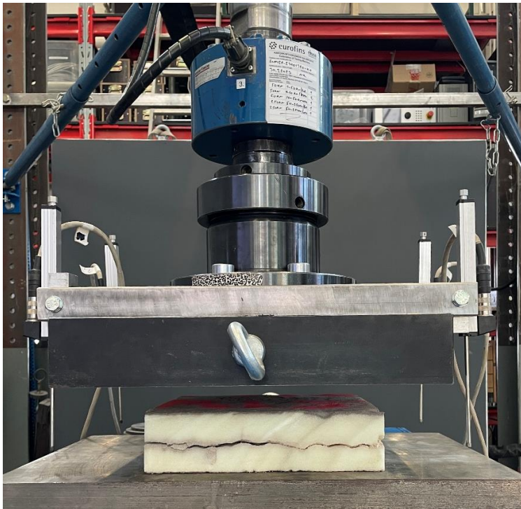
Kuva 24. Koekappale 25 ennen puristuskokeen alkamista.
