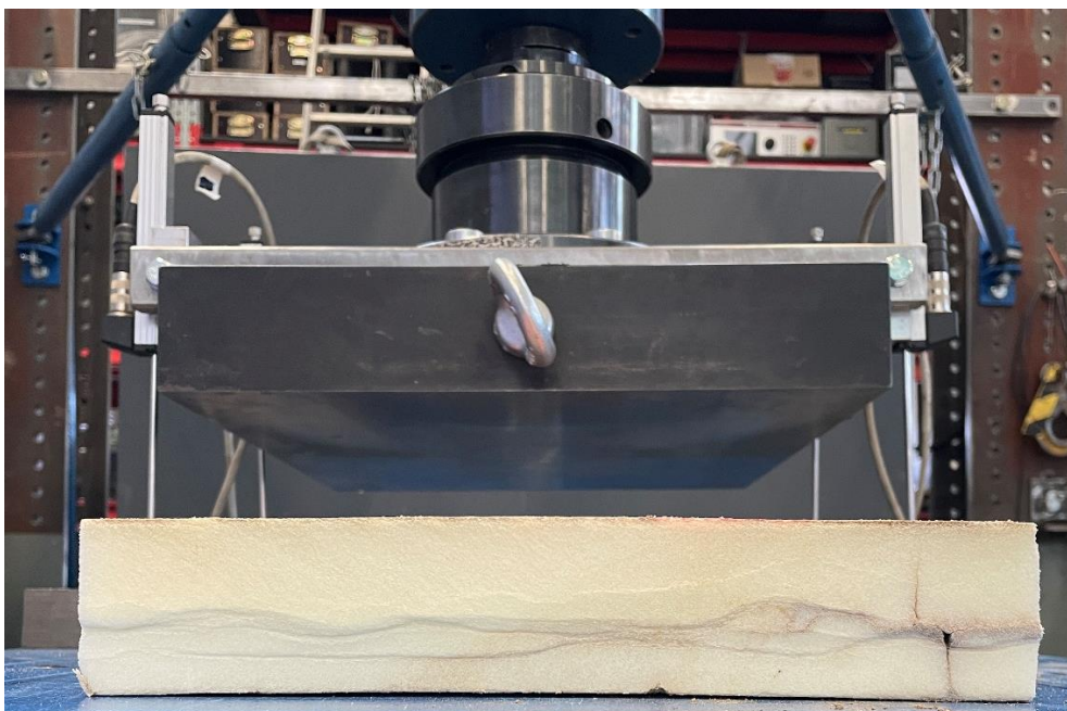
Kuva 25. Koekappale 25 heti puristuskokeen jälkeen.
