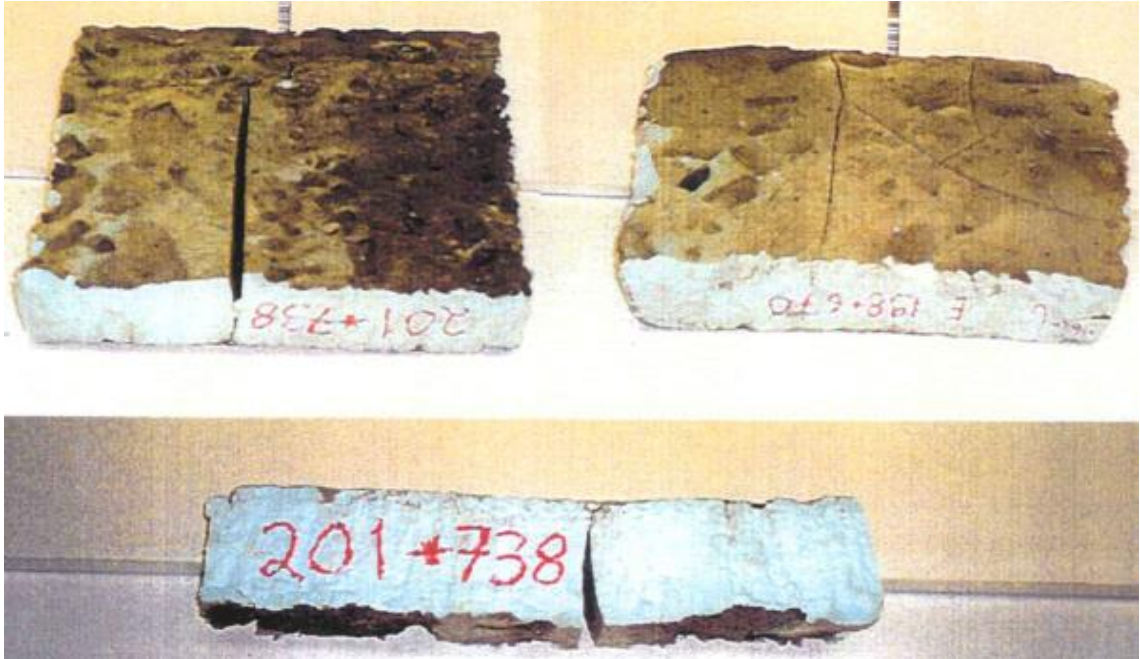
Kuva 14. Dowin valmistamien levyjen halkeamia ja sepelin painaumia levyjen pinnassa (Nurmikolu & Kolisoja 2001, s. 62).
