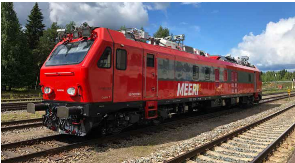
Kuva 35. Radantarkastusvaunu MEERI on suunniteltu ja rakennettu MERMECin toimesta Italiassa (Rautatietekniikka 3/2022, s. 52).
