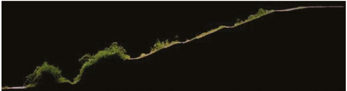
Kuva 16. Poikkileikkaus fotogrammetrialla muodostetusta digitaalisesta maastomallista, jossa näkyy myös kasvusto (Luhmann et al. 2020, s. 707).
