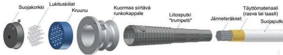
Kuva 5. Tartunnallisen jännepunoksen rakenne (Kärki 2018, s. 10).
