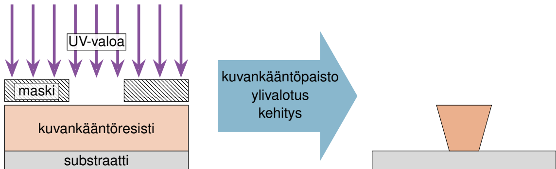
Kuva 4.1. Litografiavaiheen periaate.
