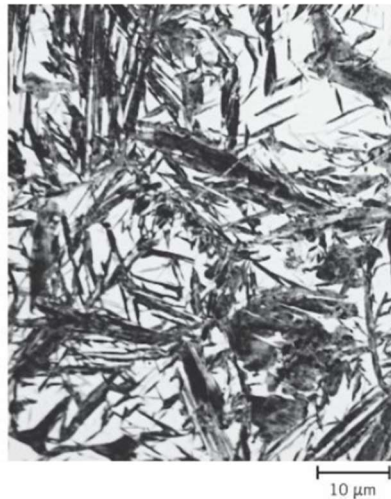
Kuva 8: Mikrorakenne, jossa martensiittia (mustat alueet) ja jäännösausteniittia (valkoiset alueet) [6]
