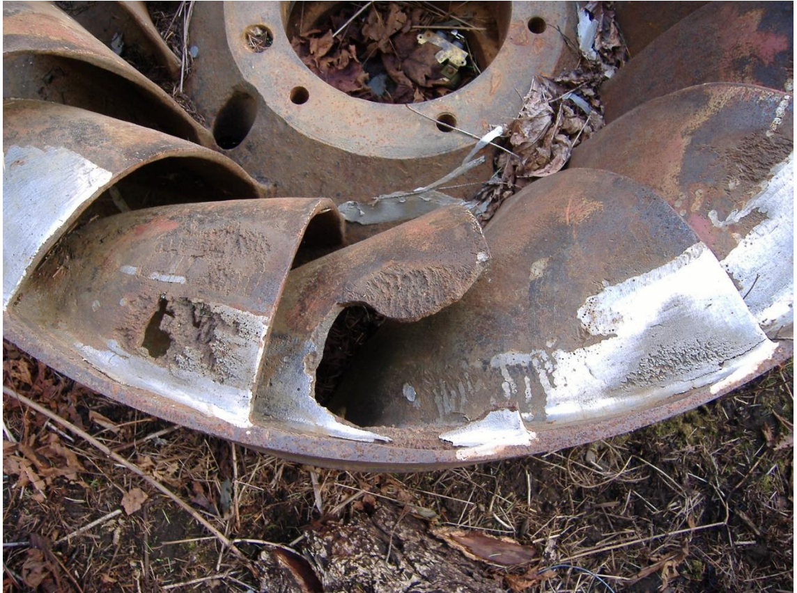
Kuva 1. Kavitaation aiheuttamaa eroosiota Francis-turbiinissa Wikipedia CC By 2.5 [7]
