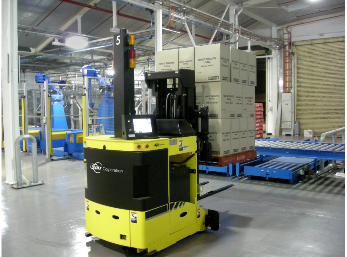
Kuva 2. JBT:n valmistama trukkimallinen vihivaunu. Kuvasta erottuvat vihivaunulle tyypilliset turvallisuusvarusteet, kuten varoitusvalot ja hätäpysäytyslaite. Wikimedia Commons, Agv.forktruck2.jpg, public domain, vapaasti yleisessä käytössä, käyttäjältä AutoGuidedVehicles. Saatavissa: https://upload.wikimedia.org/wikipedia/commons/6/62/Agv.forktruck2.jpg
