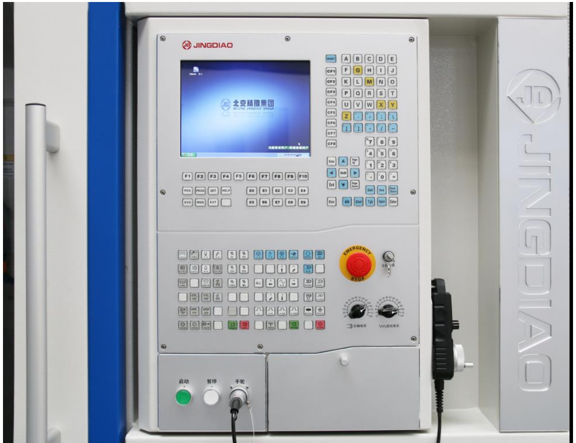
Kuva 1. Kiinalaisen Beijing Jingdiao valmistaman Jingdiao JD50 -CNC-järjestelmän ohjauspaneeli koneistuskeskuksen ohjaamiseen. Kuvassa erottuvat hyvin muun muassa punainen hätäpysäytyslaite sekä sen alapuolella mustat kiertonupit karan pyörimis- ja syöttönopeuden säätämiseen. Kuvassa erottuu myös niin ikään musta käsipyörä, jota voidaan käyttää muun muassa karan sijainnin hienosäätöön. Wikimedia Commons, Jingdiao JD50 Control System.png, lisensoitu Creative Commons Nimeä-JaaSamoin 4.0 Kansainvälinen -lisenssillä, käyttäjältä HafeezJD. Saatavissa: https://commons.wikimedia.org/wiki/File:Jingdiao_JD50_Control_System.png
