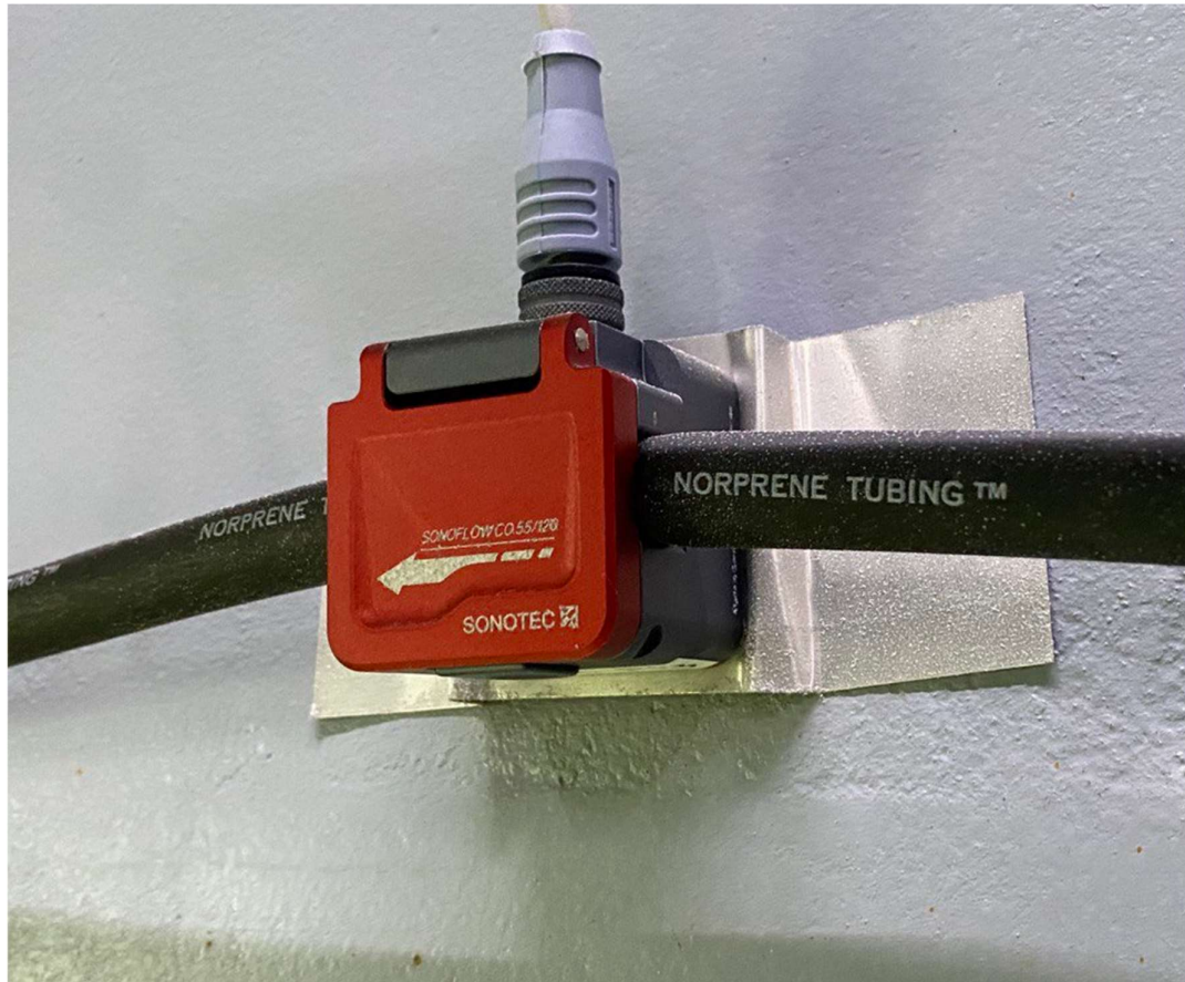
Kuva 7. Sonotec SONOFLOW CO.55. virtaamittari ferrikloridi syöttöputken ympärillä Ferrikloridin pinnanmittaus on oleellinen kokeellisen työn kannalta, sillä pinnanvaihtelua tullaan käyttämään varmentamaan virtaamittausta referenssiarvona. Tässä mittarina toimii Endress+Hauserin valmistama Prosonic M FMU41 ultraääneen perustuva pintamittari. Laitoksella kemikaalisäiliönä toimii suorakulmion muotoinen allas, joka on katettu metallikannella. Pintamittari asennettuna kemikaalisäiliön kanteen näkyy Kuvassa 8.
