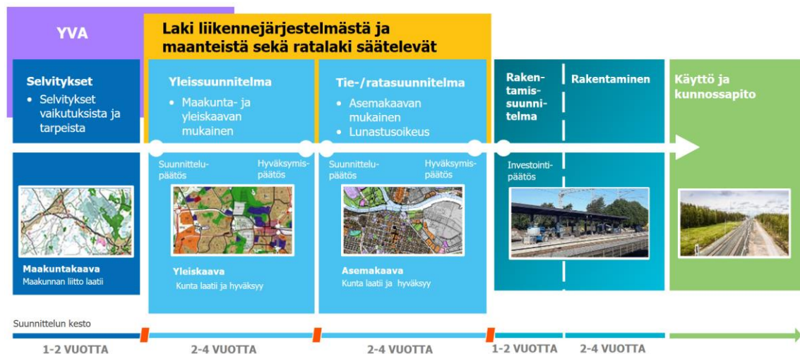
Kuva 1. Rata- ja tiesuunnittelun hankkeen vaiheet sekä niiden kytkeytyminen maankäytön suunnitteluun. (Väylävirasto 2022a)
