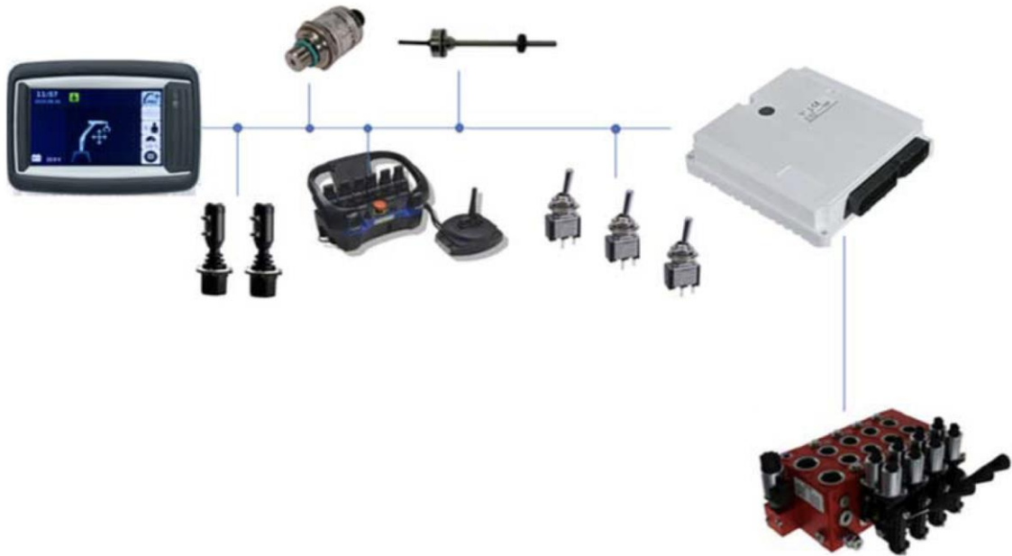
Kuva 14. xCrane PRO-järjestelmän rakenne
