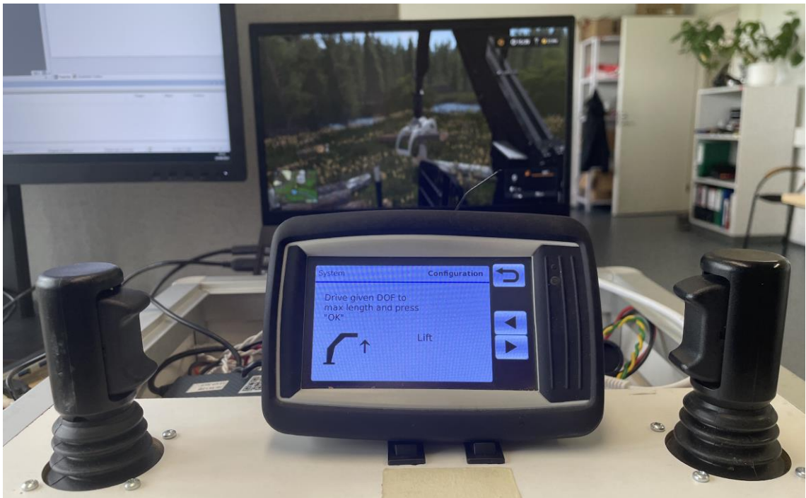
Kuva 25. Nostoliikkeen poikkeaman määrittämisen lähtötilanne
